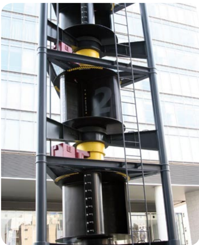
Aerogenerador de eje vertical (tipo Savonius).
