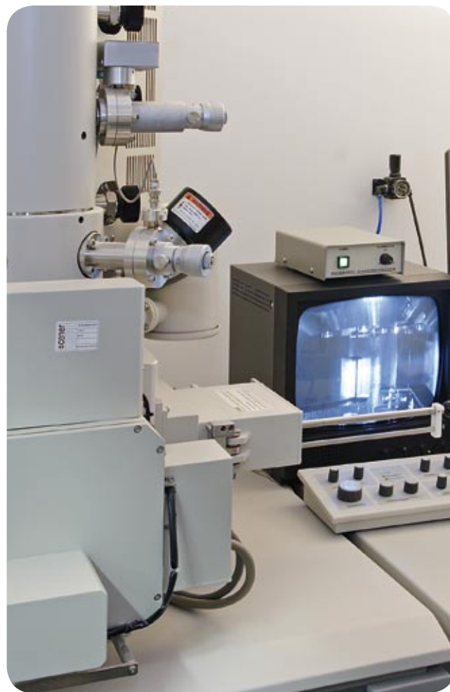
Microscopio electrónico para estudiar la morfología de una oblea fotovoltaica.
