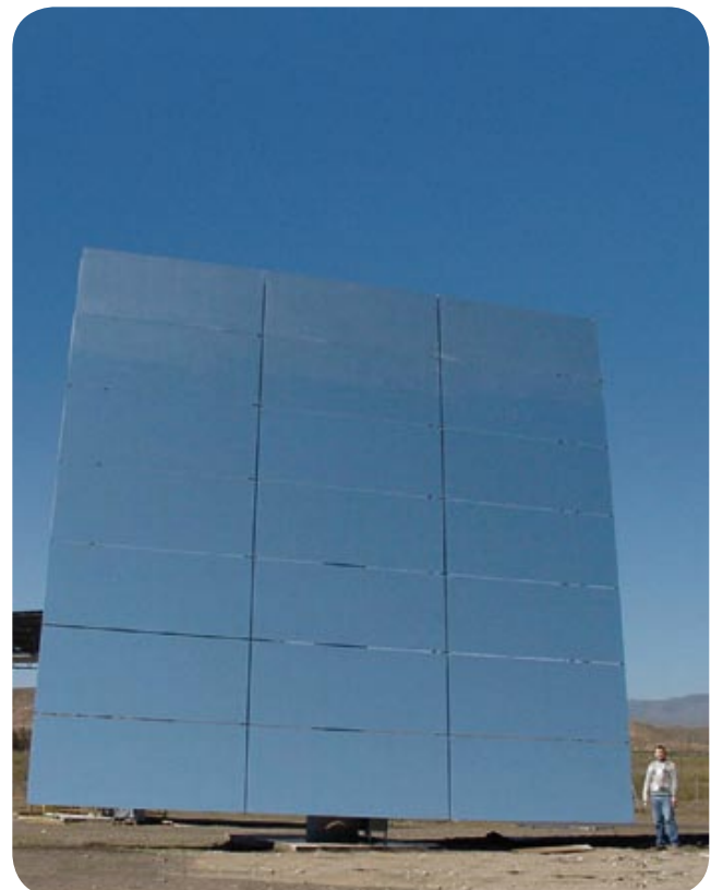
Helióstato de vidrio-metal de 90 m 2 de superficie reflexiva.
