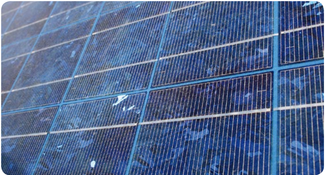
Detalle de panel fotovoltaico de silicio policristalino.
