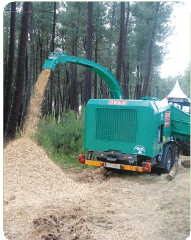
Astillado de biomasa a pie de pista.
